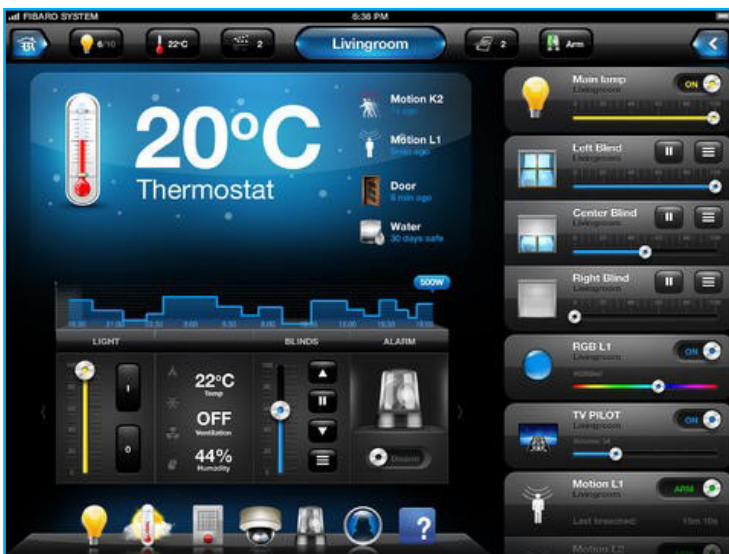
SYSTÈME INFORMATIQUE AVEC PANNEAU DE COMMANDE PROGRAMMABLE Système programmable de haute précision pour les projets de grande envergure et les bâtiments intelligents. Peut être relié à des systèmes de gestion de l'énergie.
